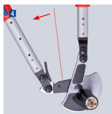
4 Etter første delsnitt åpnes skaftet etter skralleprinsippet
