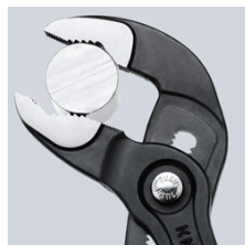
Forskjøvete tenner mot dreieretningen gir en selvklemmende effekt og forhindrer rutsjing på arbeidsstykket
