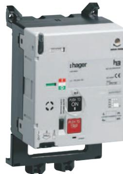
Motorantriebe für 400 A- und 630 A-Leistungsschalter besitzen eine mechanische Flagge mit EIN, AUS und AUSGELÖST, welche den Status des Leistungsschalter anzeigen. Mit dem dafür vorgesehenen Hebel können die Motoren manuell geladen werden.
