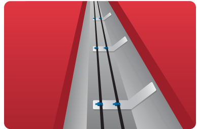
Spaceclip 用来固定电缆，缓解锋棱带来的压力。
