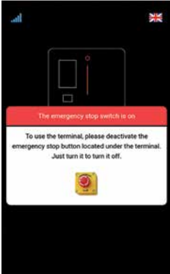
Figure 5. Berøringsskjermen når nødstopknappen er trykket på
