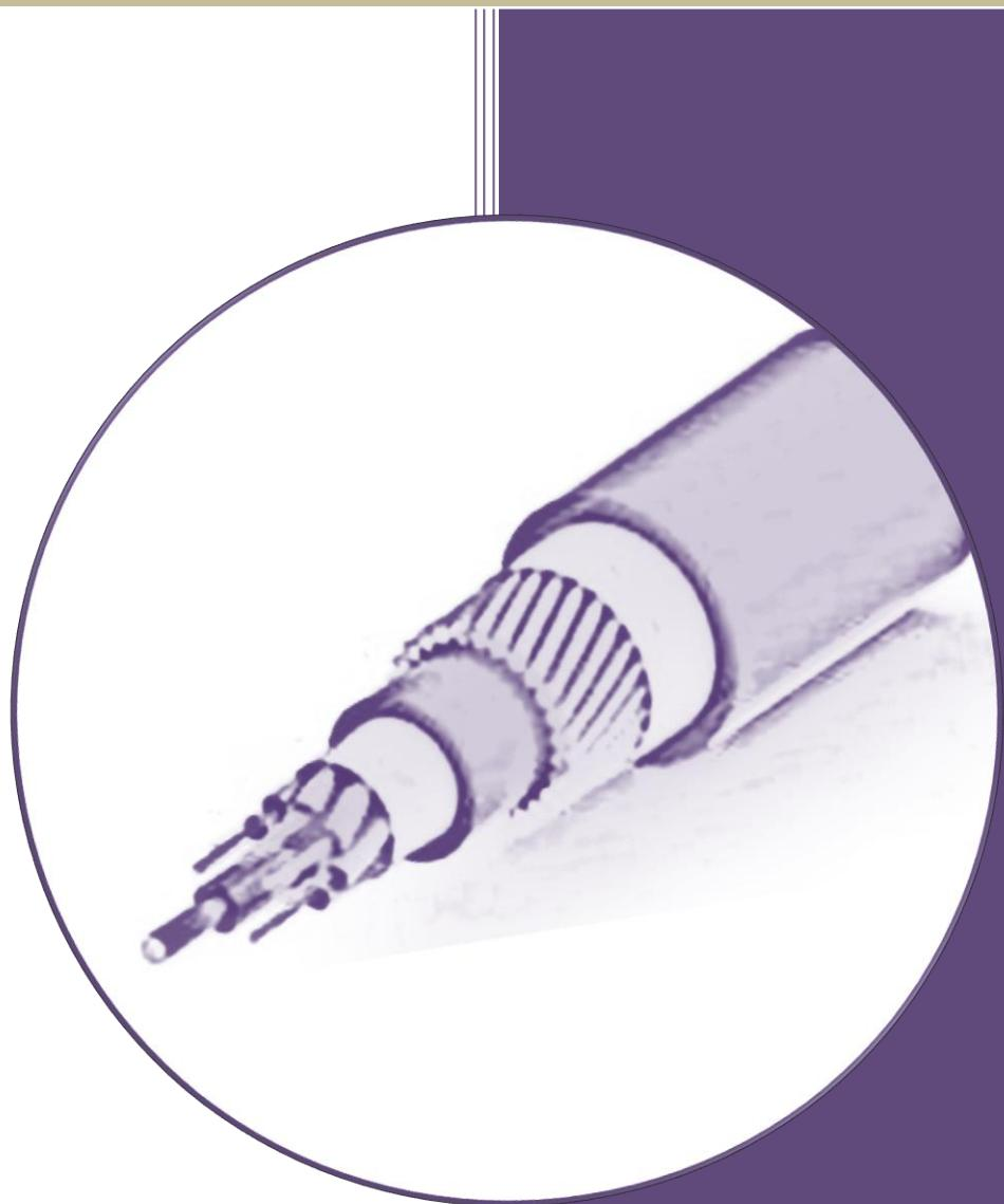
**FibreCore UWIC** er en sjøkabel med ett lag med galvanisert ståltrådarmering og med ytre kappe av slitesterk polyetylen. Kabelen leveres med 12 til 288 G.652D fibre som er merket i henhold til Telenor farge kode. Kabelen egner seg for forlegning i grunne innsjøer, vassdrag eller i grunne farvann langs kysten.
