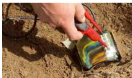
... Elektrisk måling kan lett utføres etter at boksen er innkapslet, den elastiske massen er selv-reparerende.
