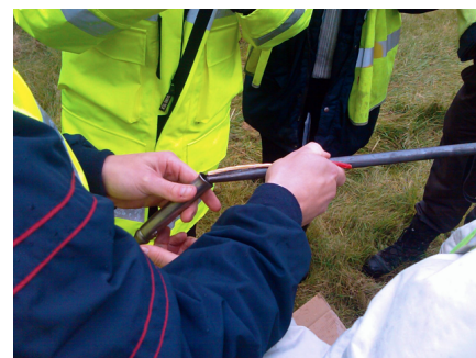
3. Jordlinan låses fast i den härdade stålspetsen med främre röret.
