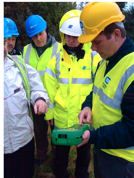
2. Mätning av markens resistivitet.
