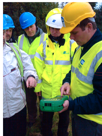
Mätning av jordtagets avledningsresistans.
