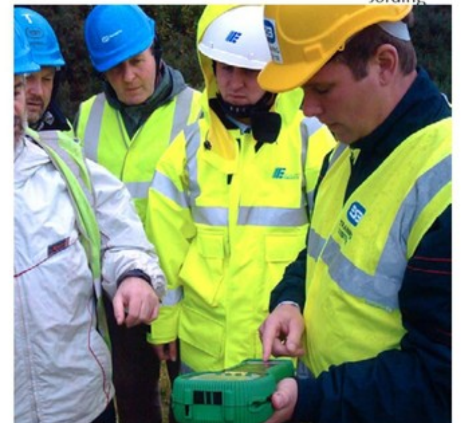
Måling av jordingens avledningsresistans
