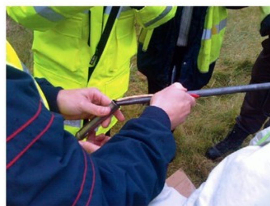
3. Jordlinen låses fast i den herdede stålspissen med det fremre røret.
