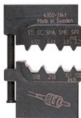
OFO5432 ST, SC, SMA, SMB, SFR fiber optik. El-nr. 2997 202 634
