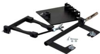
110770-000 Arbeidsjigg, FOSC-400 Brukes til å feste skjøteboksen til et stødig underlag ved montering.
