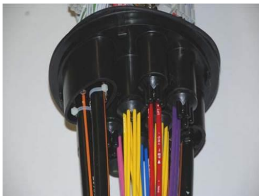
Typisk kabel innføring med kald forsegling
