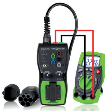
Elma 6100EVSE tilsluttet med BNC adapter til Metrel A1532
