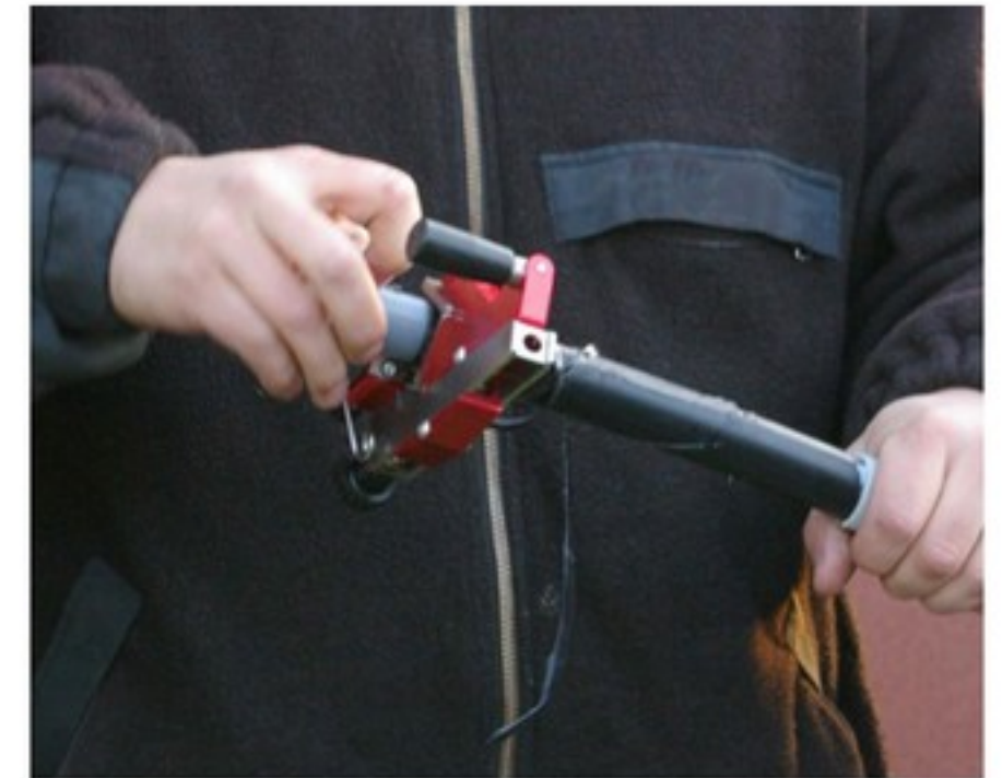
Det stabile avisoleringsverktøyet FBS1722 gir bedre og jevnere resultat enn de fleste andre avisoleringsverktøy.
