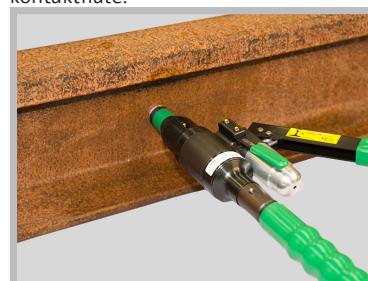
Monteringsverktøyet settes på framstykket. Press inn håndtaket til du hører et «klikk». Når du har trukket til forbindelsen med momentnøkkelen, er Railbonden festet.
